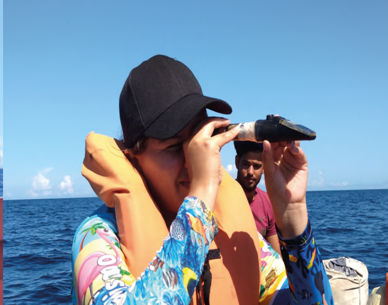
Estudiante voluntaria de la UDO, Maurys Aponte, realizando medición de salinidad con refractómetro.
