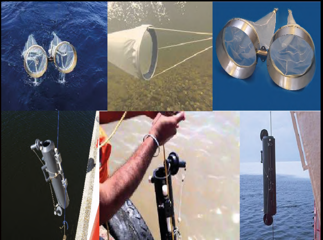
Figura 4. Muestreo con redes de plancton tipo bongo (arriba) y muestreo con botella de Niskin (abajo).
